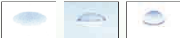
水接触角25° (ファイン4Fセラミック) 水接触角50° (従来の低汚染塗料) 水接触角80° (従来の塗料)
