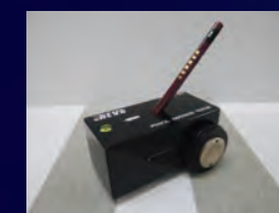
オールグッド社製JIS規格対応鉛筆硬度試験器(750g)
